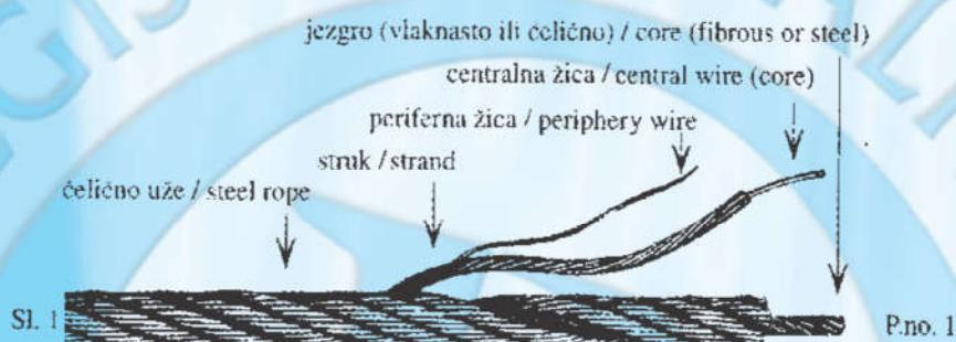
Na slici se vidi da je određen broj žica po zadatom geometrijskom rasporedu usukan u struk, a određen broj strukova po zadatom geometrijskom rasporedu oko jezgra použen u uže.
