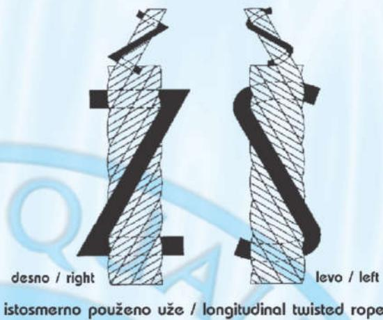
Užad paralelnog použavanja (Z/Z i S/S) su otpornija na habanje nego užad unakrsnog použavanja jer je uže većom površinom u kontaktu sa spoljnim materijalom, ali se može koristiti samo tamo gde su oba kraja užeta fiksirana, te ne može doći do rotiranja.
